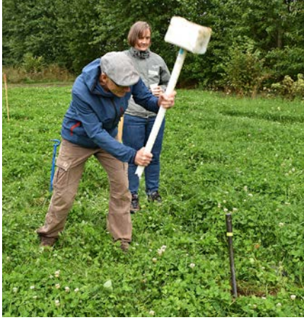
Einschlagen der Metallröhre für die Bodenprobe.
