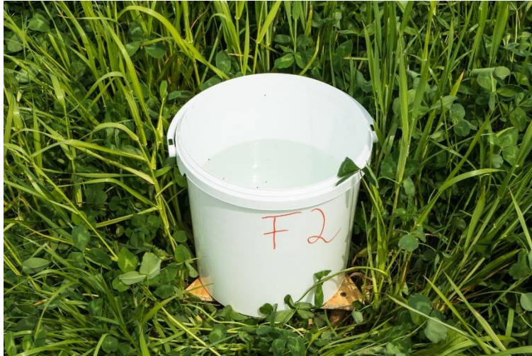
Abbildung 7: Foto eines Verdunstungseimers auf der Klee grasfläche bei Rieckens Landmilch (Foto: Rainer Wolf)
